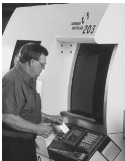
Tony Clark est sur le point de télécharger le programme de la pièce, réalisé sur un PC de bureau grâce à TB DECO et enregistré sur une carte mémoire.
