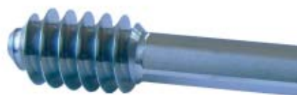
Tourbillonnage du filet en contre-opération (3 passes ébauche finition) en temps masqué.
