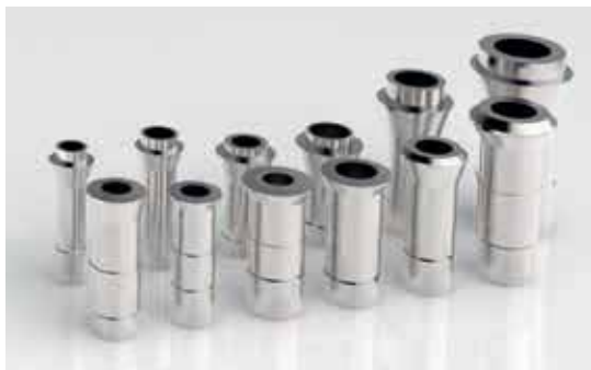
Exemples de canons et pinces standards livrés avec la machine.
