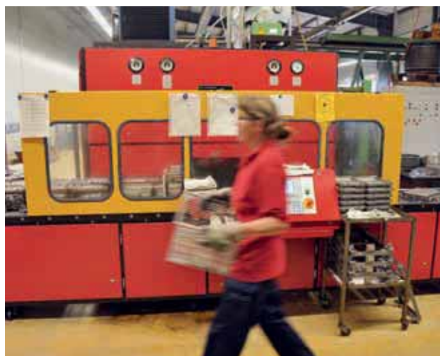
Avant la mesure automatique, les pièces sont nettoyées dans un tunnel de lavage performant. Les 10 collaborateurs de l'entreprise mettent leur savoir-faire au service des clients.
