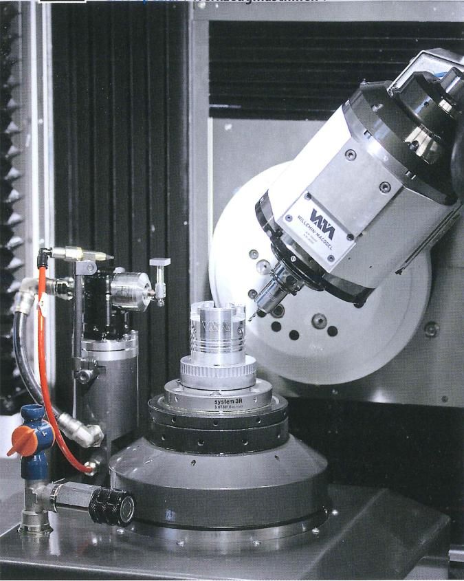
Die 508MT2 X1000 ist ein Multiprozess-Bearbeitungszentrum für die Bearbeitung komplexer Werkstücke ab Stangen mit Ø 65 mm.
