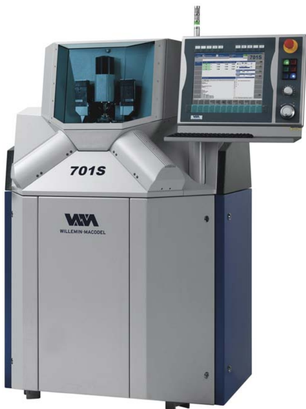
La machine 701S à trois axes dotée d'une cinématique Delta minimise les masses en mouvement, permettant ainsi un travail d'une très haute précision tout en réduisant l'impact environnemental grâce à une très faible consommation d'énergie.
