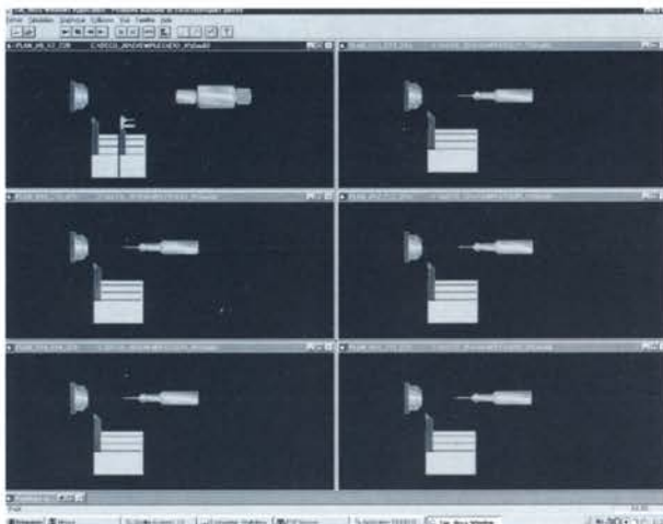
Sim Deco Version 4.0, das Simulationsprogramm der Werkzeugbahn
