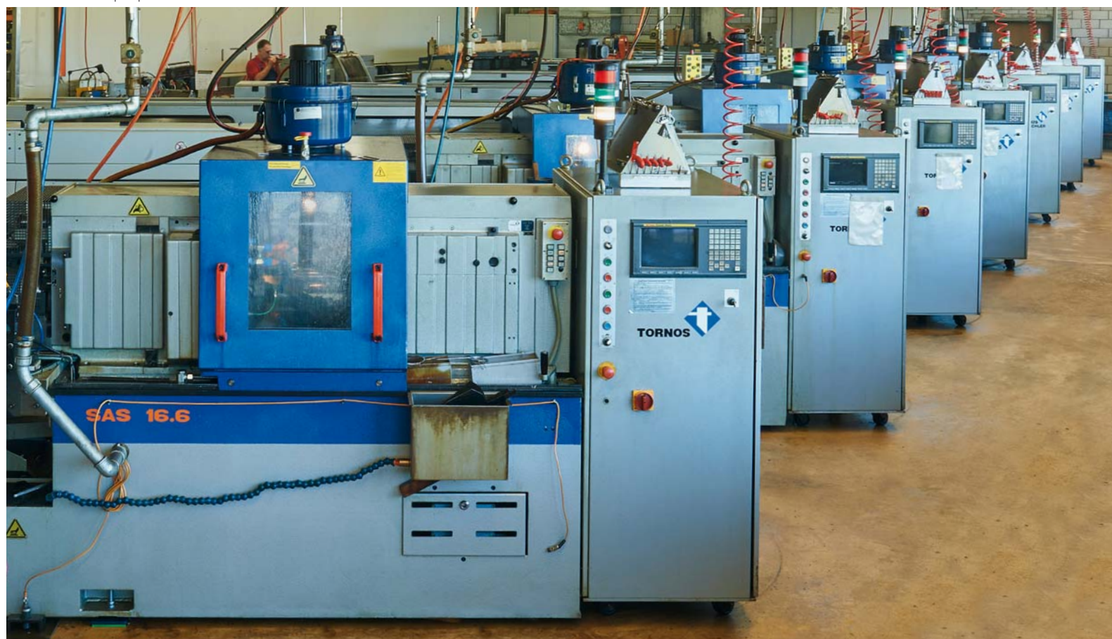
17 tours automatiques multibroches à cames SAS 16.6 et AS 14 fabriqués par Tornos sont utilisés au total chez RB-Cema
