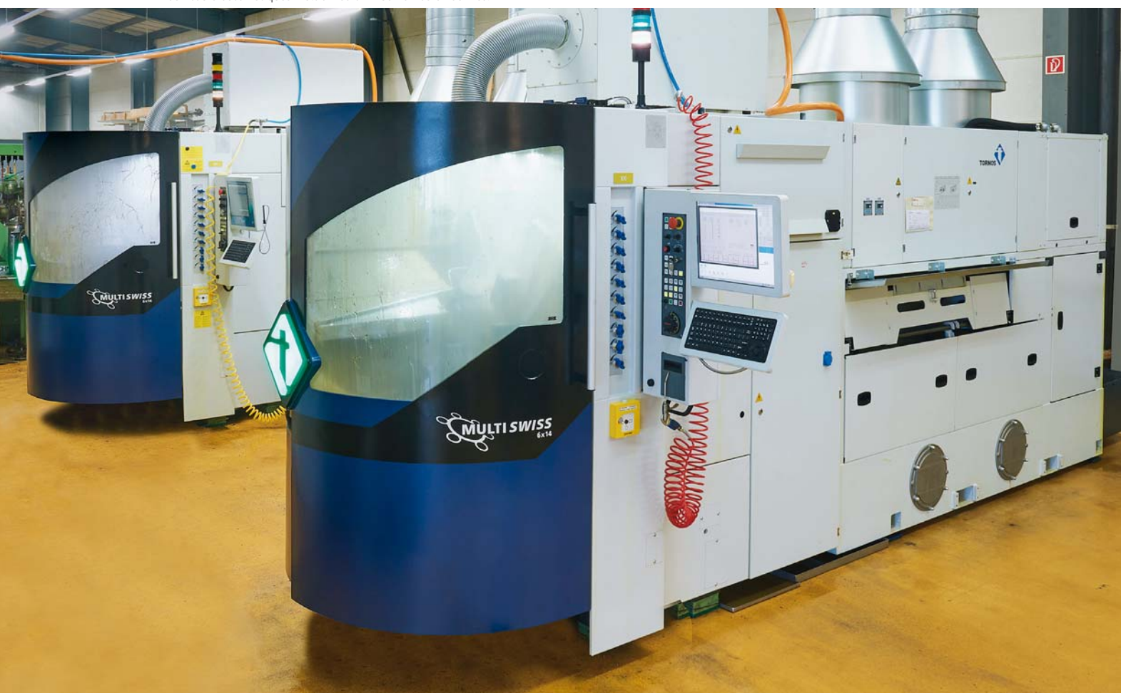
Deux tours automatiques MultiSwiss 6x14 de Tornos en service.
