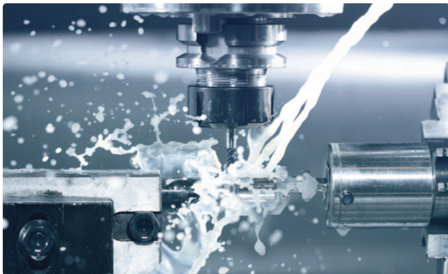
Pour certaines opérations et matières, l'usinage à l'émulsion est indispensable. L'eau et les différents composants de l'émulsion doivent être parfaitement adaptés afin d'assurer un maximum d'efficacité.
