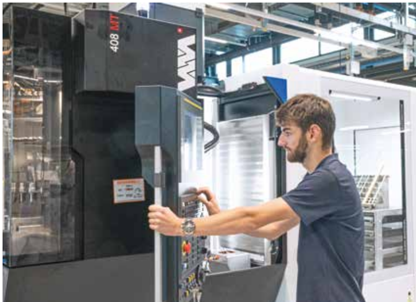
Cellule de production Willemin-Macodel avec centre d'usinage 408MT et sa robotisation sur mesure.
