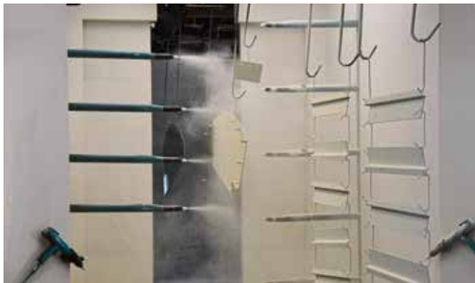
Installation automatisée de peinture par poudrage.
