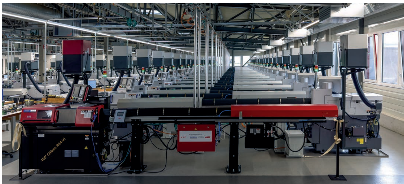
Image classique d'un atelier de décolletage. Les ravitailleurs apportent non seulement l'autonomie et la garantie de fonctionnement en continu, mais également de nombreux avantages en termes de flexibilité, de qualité et de précision.
