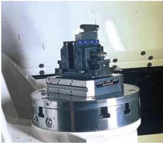
Das Erowa-VPC-Spannsystem ist die präzise Schnittstelle zwischen Maschine und Werkstückträger. So lassen sich die verwendeten Werkstückspanner automatisiert auf der Maschine positionieren.
