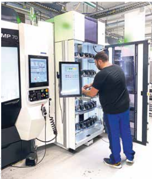
Trotz seiner kompakten Bauweise bietet das Magazin des Roboters viel Platz für verschiedene Werkstückträger.
